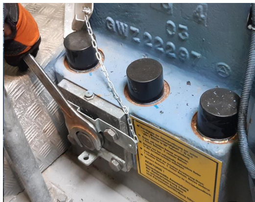
Introducción de los bulones. Inserting the pins.
