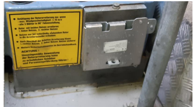
Bulones ya insertados con la pletina fijada en su posición. Bolts already inserted with the plate fixed in position.
